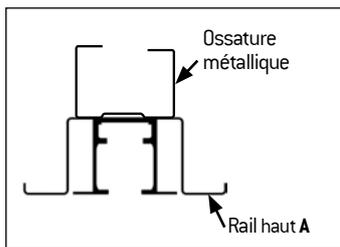
**4** Renforcer l'ossature métallique entre le rail haut A et le plafond (X8)
