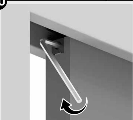
Déplacer la porte (position fermée) pour accéder à la vis du coulisseau coté coffre et serrer la vis de blocage
